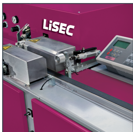
Einstellung für Rahmenbreiten erfolgt stufenlos
