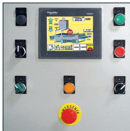
Steuertafel mit Touchscreen
