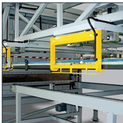
Ausgang des Laminiertunnels, automatisches Entladen der Trays in das Pufferlager
