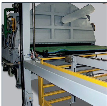
Eingang des Laminiertunnels, automatisches Beladen der Trays
