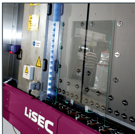
Belichtung mit Kaltlicht zur chemischen Verbindung von Beschichtung und Glas
