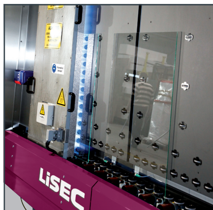
L'esposizione a luce fredda per il grippaggio chimico del rivestimento sul vetro
