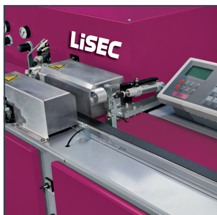
La regolazione della larghezza del telaio avviene in modo continuo
