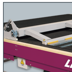
Barra di riscontro mobile per il posizionamento semi-automatico
