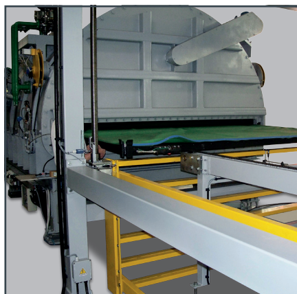
Выход из секции ламинирования, автоматическая выгрузка поддонов в буфер
