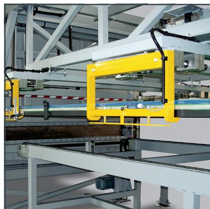
Вход в секцию ламинирования, автоматическая загрузка поддонов
