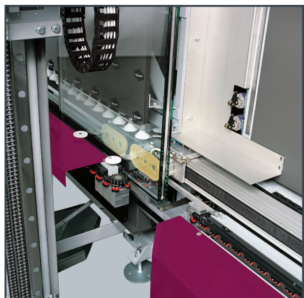
Поддерживающие присоски для транспортировки стеклопакетов малых размеров
